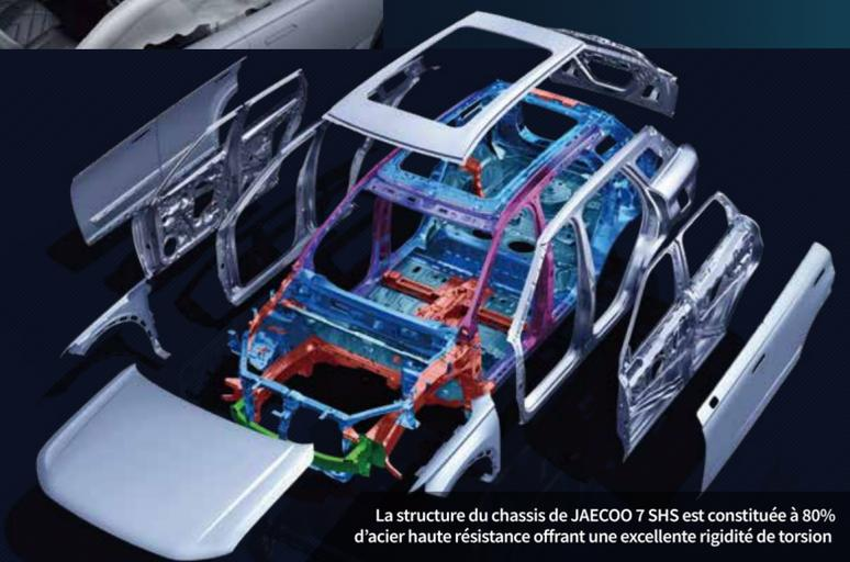
La structure du châssis de JAECCO 7 SHS est constituée à 80% d'acier haute résistance offrant une excellente rigidité de torsion
