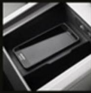
**Audi phone box :** compartiment situé sous le tableau de bord central, équipé d'un chargeur de téléphone par induction et d'un amplificateur de téléphonie. Lorsque votre téléphone y est placé, il se charge sans fil et son signal est amplifié en passant par l'antenne.
