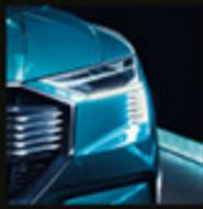
**Matrix LED HD :** Cette technologie innovante répartit le faisceau lumineux de façon optimale. Ceci permet d'éviter d'éblouir les conducteurs des véhicules qui vous précèdent ou arrivent en sens inverse tout en assurant un éclairage parfait des autres zones périphériques. La répartition de la lumière est garantie par l'activation et la désactivation de segments lumineux individuels. L'éclairage de la route est ainsi nettement amélioré ce qui signifie aussi plus de sécurité et de confort.
